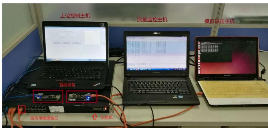
图 9 智能电网工业控制系统实验平台
