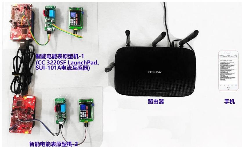
图 8 SEP 2.0 通信协议栈及原型机
